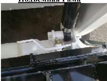
Подъемные мачты выполнены из специального профиля, который обеспечивает отличный обзор. Устройство крепления навесного оборудования выполнено в быстросъемном исполнении. Это позволяет менять одно навесное оборудование на другое за считанные минуты, и не требует физических усилий. Возможна установка различного навесного оборудования: ковш, вилы, мини-экскаватор, щетка подметальная, бетоносмеситель, фреза, гидробур, гидромолот и многое другое.
